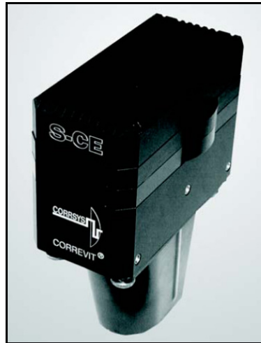
Rysunek 5. Czujnik pomiaru prędkości Correvit S-CE. Źródło: własne
