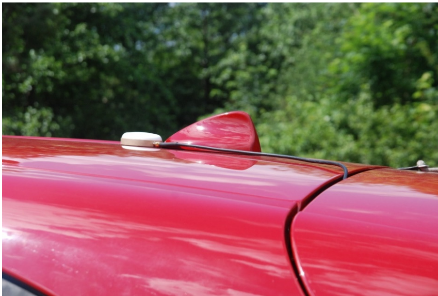
Rysunek 25. Sposób zamontowania pojedynczej anteny GNSS G5 Ant-2AMNS1. Źródło: Badania własne
