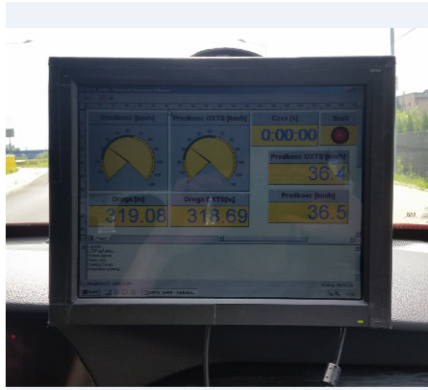
Rysunek 21. Widok monitora z bieżącymi danymi \mu EEP11 firmy CORRSYS-DATRON. Źródło: Badania własne
