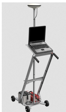
Rysunek 15. Stacja bazowa GNSS [9]
