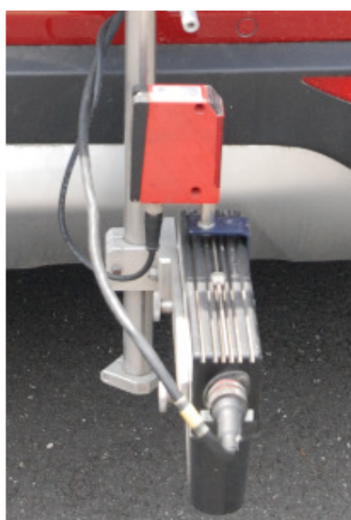
Rysunek 23. a) słupek pomiarowy do wyzwalania początku i końca odcinka pomiarowego, b) zamocowana fotokomórka na głowicy CORREVIT w tylnej części pojazdu. Źródło: Badania własne
