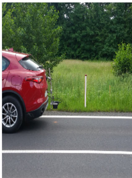
Rysunek 23. a) słupek pomiarowy do wyzwalania początku i końca odcinka pomiarowego, b) zamocowana fotokomórka na głowicy CORREVIT w tylnej części pojazdu. Źródło: Badania własne
