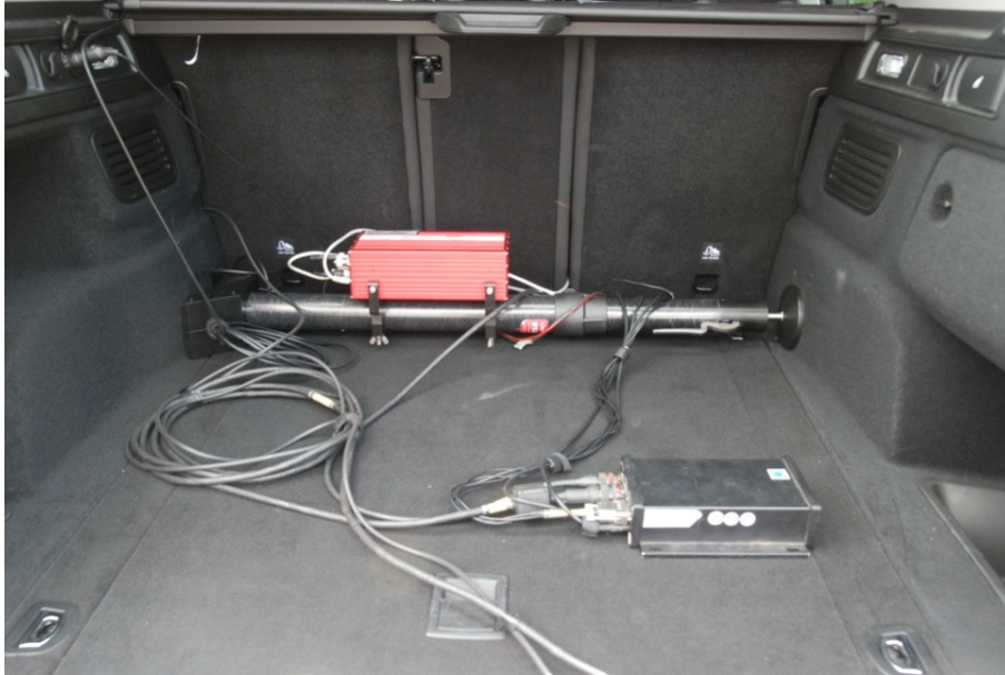
Rysunek 24. Sposób zamontowania urządzenia GSP GNSS RT2002 V2. Źródło: Badania własne
