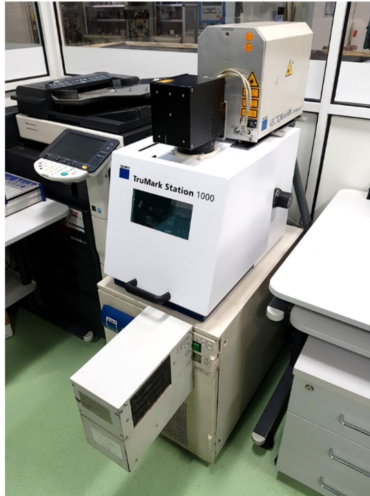
Rysunek 6. Stanowisko znakowania laserowego [19]
