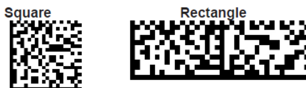
Rysunek 4. Kod DataMatrix w formie kwadratu i prostokąta [17]
