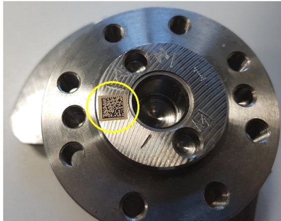
Rysunek 9. Element z wykonanym kodem DataMatrix (obszar zaznaczony żółtą obwódką) [19]
