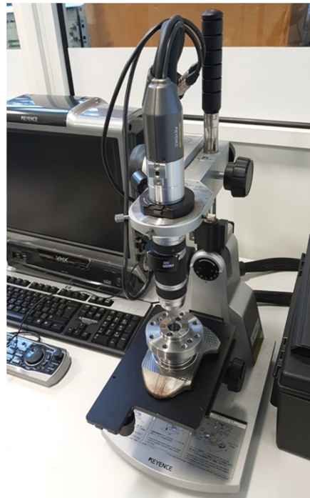
Rysunek 8. Stanowisko mikroskopu Keyence VHX-1000 do oceny jakości kodów DataMatrix [19]
