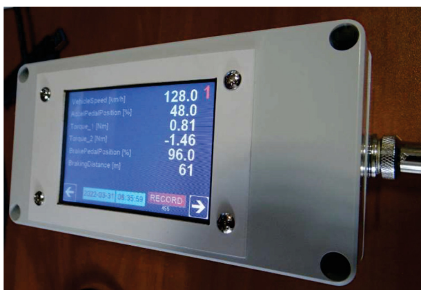
Rysunek 4. Skaner parametrów bieżących z ECU silnika badanego pojazdu
