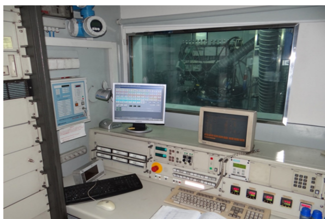
Rysunek 2. Widok pulpitu sterowniczego wyposażonego w system sterowania Schenck i system akwizycji danych [5]
