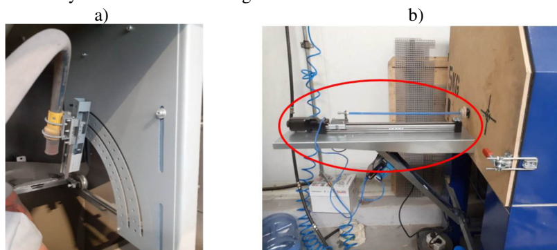
Rysunek 3. Stanowisko doświadczalne; a) komora obróbcza, b) układ liniowego napędu wózka (obwódka koloru czerwonego)[17]
