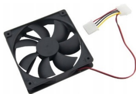
Rysunek 21. Wentylator komputerowy. [źródło: https://imged.pl/wentylator-radiator-wiatraczek-komputerowy-2-1520497.html , 05.05.2020 rok]
