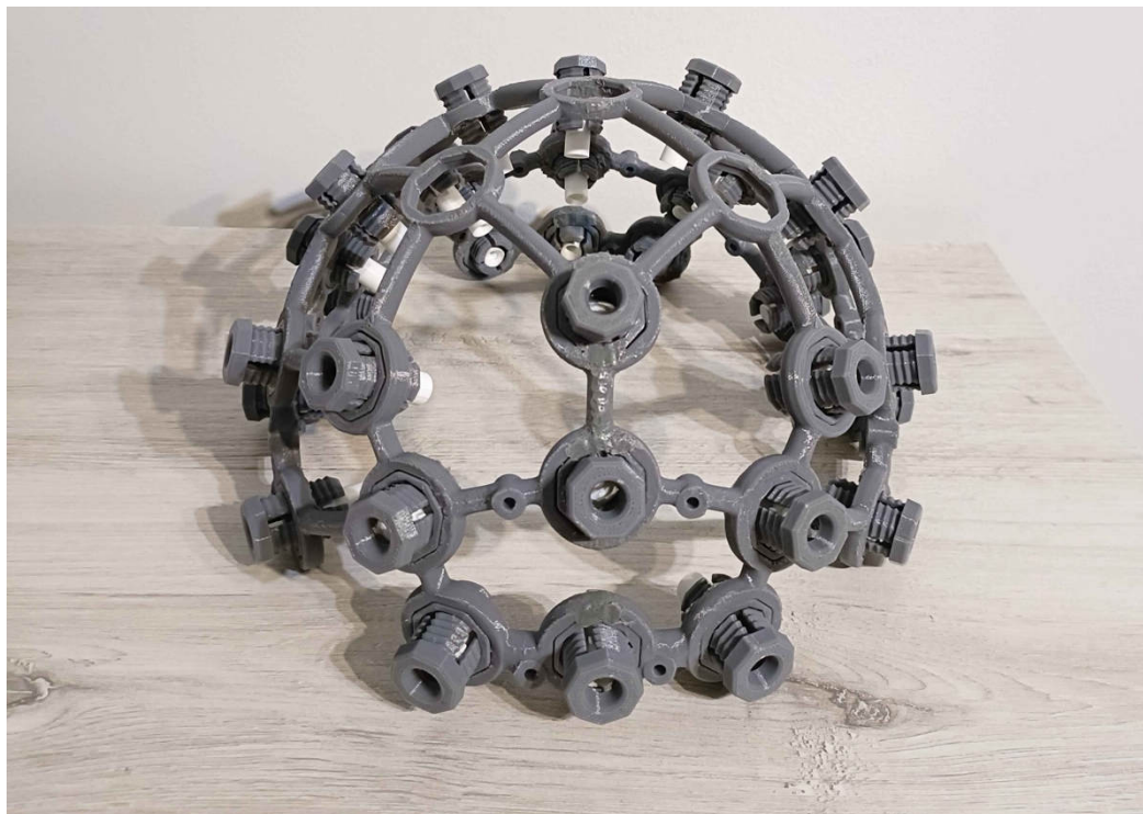
Rysunek 5. Headset EEG wydrukowany na drukarce Prusa i3 MK3S
