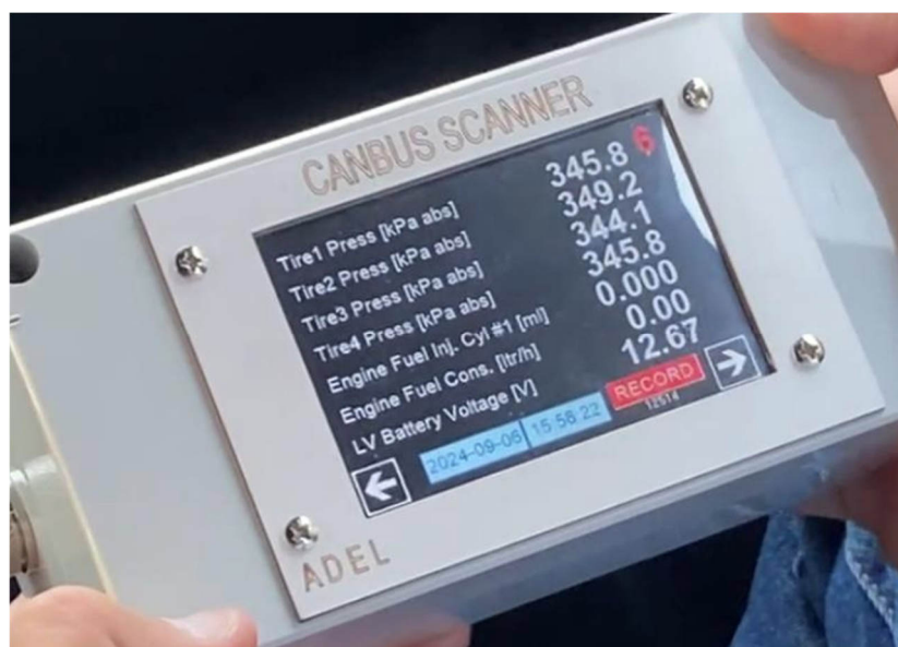
Rysunek 5. CAN Scanner produkcji ADEL wykorzystywany do badań (Opracowanie własne)
