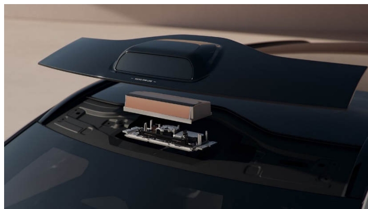
Rysunek 5. System LIDAR zamontowany w przedniej części dachu samochodu Volvo XE90 [7]
