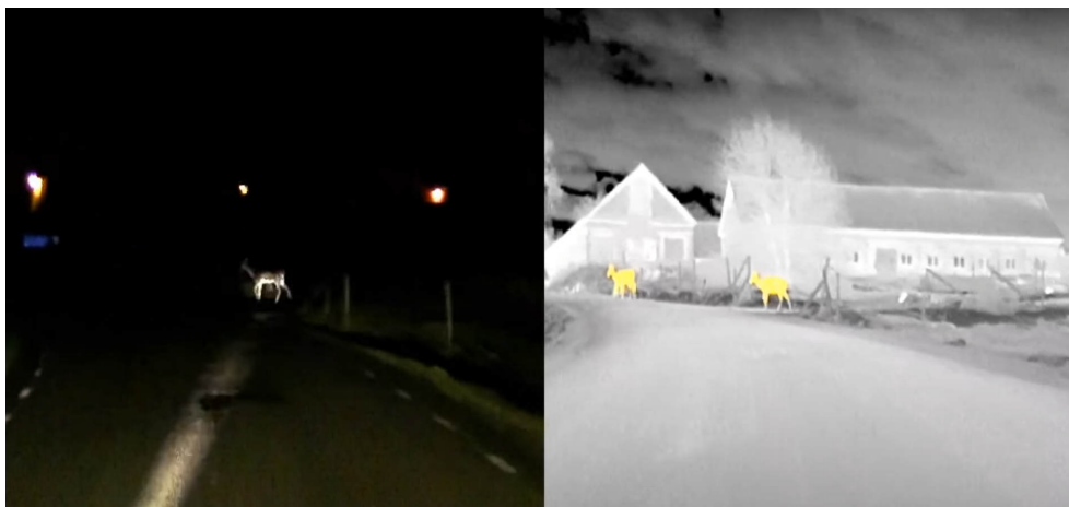
Rysunek 6. Porównanie widoczności z kabiny pojazdu bez kamery termowizyjnej (po lewej) i z kamerą termowizyjną (po prawej) [10]
