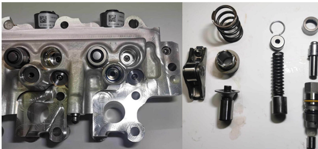
Rysunek 3.1 Współpracujące elementy układu multiair
