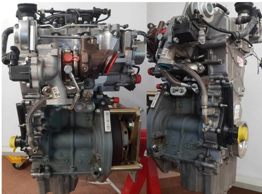
Rysunek 2.1. Obiekt badań - silnik 0.9 TwinAir [5]
