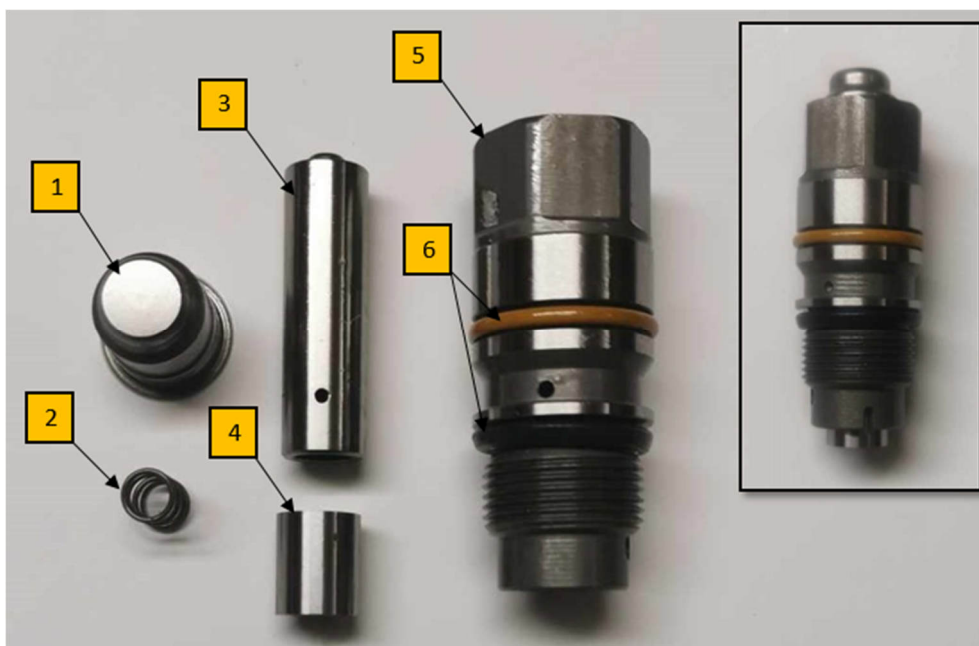
Rysunek 3.3. Element pompujący dolny – elementy składowe: 1 – pokrywa tłoka górnego, 2 – sprężyna, 3 – tłok górny, 4 – tłok dolny, 5 – obsada, 6 – o-ring
