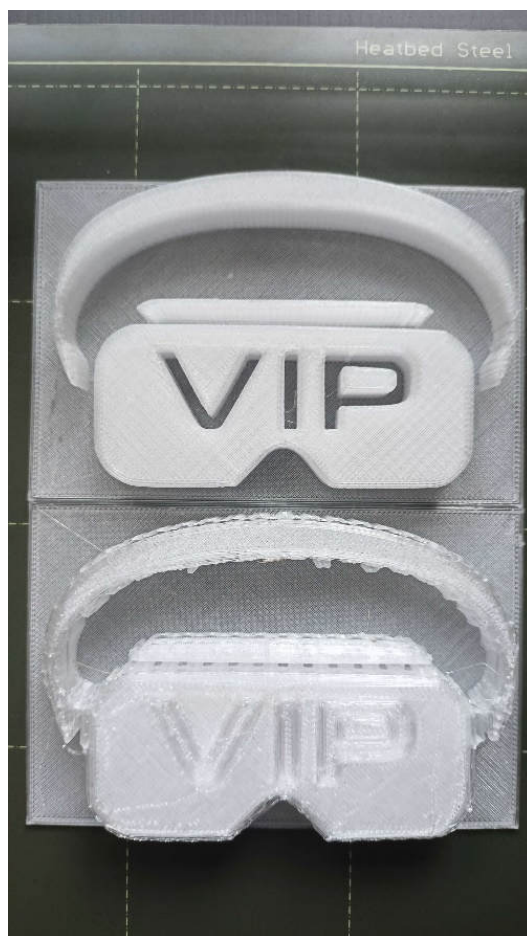
Rysunek 12. Przezroczyste obiekty przy zastosowaniu różnych wartości wypełnienia. Obiekt na górze 30%, a na dole 20%. [opracowanie własne]
