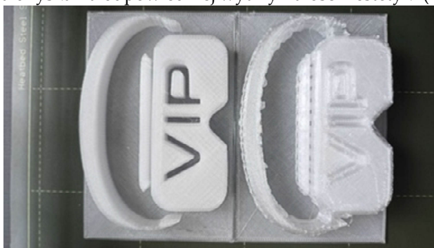
Rysunek 14. Detal wydrukowany przy wypełnieniu 80% (po lewej) oraz ten sam element (po prawej) wydrukowany przy wypełnieniu 30%
