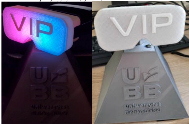
Rysunek 17. Finalny wygląd okularów na podstawie z zastosowaniem diod LED (opracowanie własne)
