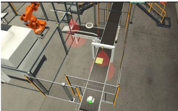
Rysunek 16. Kontrola koloru detalu [14]
