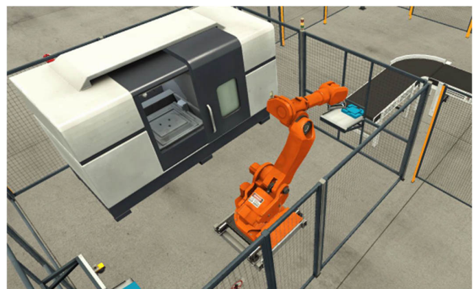
Rysunek 24. Odkładanie obrobionego detalu [14]
