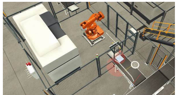
Rysunek 19. Kontrola detalu przed podaniem do centrum obróbczego [14]
