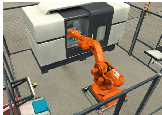
Rysunek 22. Umieszczanie pobranego detalu w obrabiarce [14]
