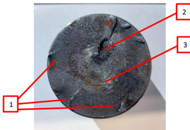
Rysunek 3. Obserwowany przełom - część próbki po regeneracji.
