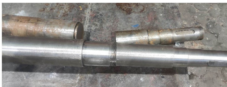
Rysunek 1. Wał, który uległ awarii (u góry) oraz nowy wał (w dolnej części zdjęcia)
