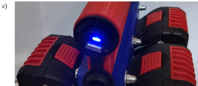
Rysunek 8. Widoki zmontowanego urządzenia: a) od strony woltomierzy i przetwornicy, b) od strony przetwornicy, c) od strony dwóch akumulatorów, gdzie w gnieździe zapalniczki opcjonalnie zastosowano przejściówkę 12 V/złącze USB
