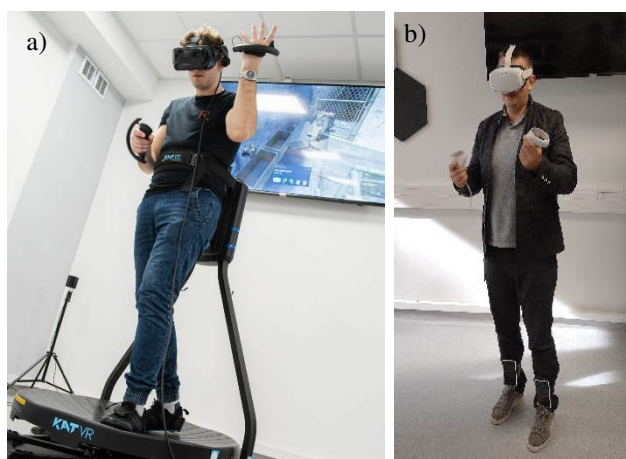
Rysunek 1. Śledzenie ruchów nóg na stanowisku VR: a) rozwiązanie komercyjne, b) propozycja rozwiązania
