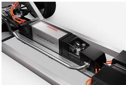
Rysunek 4. Ogniwo zastosowane w Hondzie FCX Concept [1]
