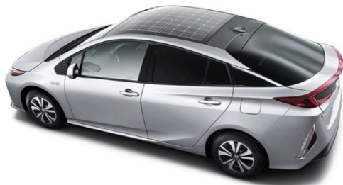
Rysunek 5. Toyota Prius z ogniwami fotowoltaicznymi [21]
