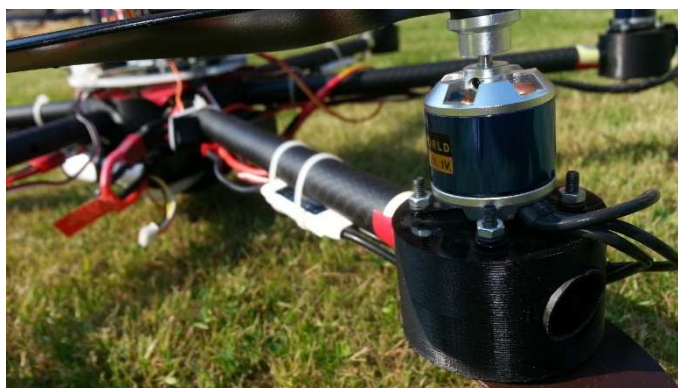
Rysunek 5. Mocowanie silnika na łożu.
