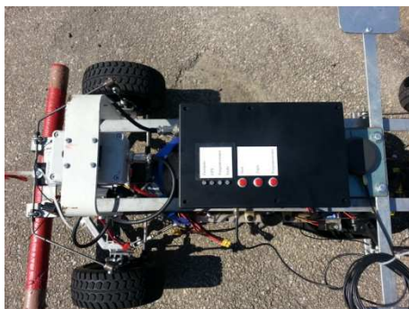
Rysunek 11. Zainstalowany układ sterujący na modelu
