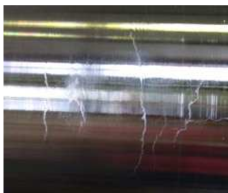
Rysunek 3. Pęknięcia na powierzchni odlewu [9]
