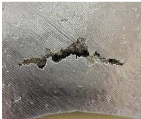
Rysunek 5. Widoczny wyraźny skurcz odlewniczy [9]
