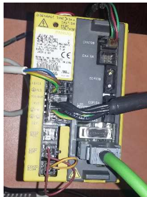
Rysunek 6. Zastosowany wzmacniacz serwonapędu [źródło własne]
