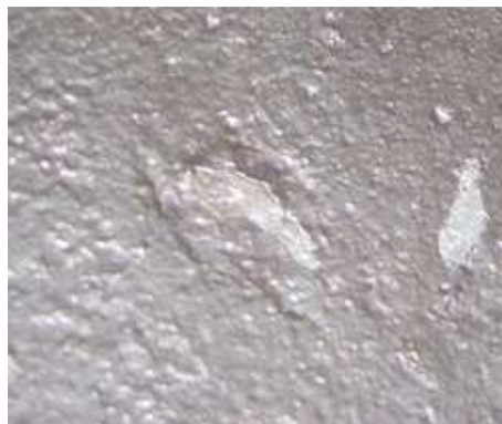
Rysunek 1. Fałdy na powierzchni odlewu [9]
