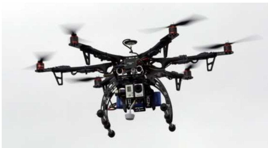
Rysunek 1. Dron sześćo-wirnikowy typu hexacopter wyposażony w kamerę i odbiornik GPS [8]
