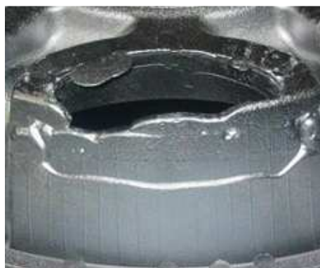
Rysunek 4. Wyraźny niedolew w obrębie otworu [9]
