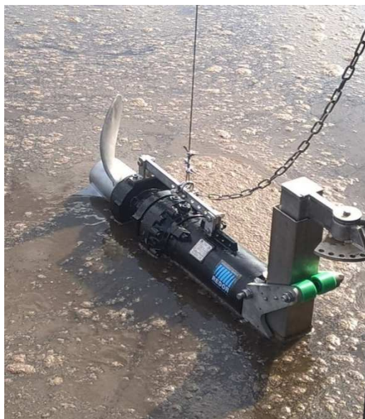
Rysunek 7. Wolnoobrotowe mieszadło zanurzalne – wyrób gotowy (opracowanie własne)
