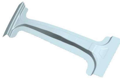
Rysunek 3. Model 3D elementu po operacji wytłaczania
