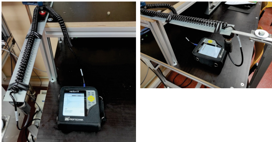
Rysunek 3. Stanowisko pomiarowe. Unieruchomiony przewód z czujnika pomiarowego. Stanowisko wyposażone w suwak zwalniający układ drgający w takich samych warunkach początkowych.
