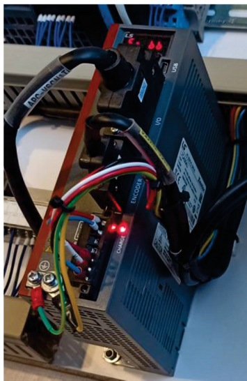
Rysunek 3. Zamontowany i podłączony do układu serwowzmacniacz [opracowanie własne]
