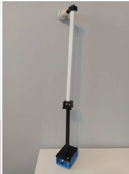
Rysunek 7. Wahadło drugiego stopnia z przykręconym czujnikiem TMM88- PCI090 [opracowanie własne]
