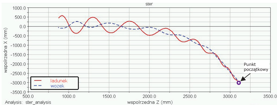
Rysunek 9. Trajektorie ruchu ładunku i wózka otrzymane podczas testów numerycznych układu regulacji zawierającego wyłącznie standardowe regulatory PID
