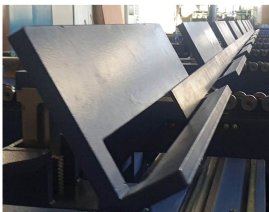
Rysunek 5. Zdjęcie fragmentu maszyny pozycjonującego płaskownik do pomiaru prostoliniowości
