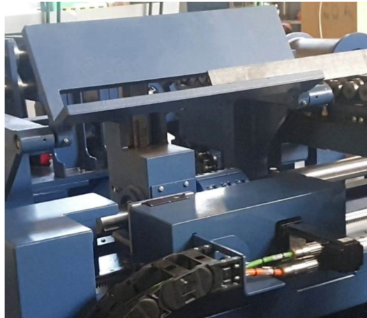
Rysunek 6. Jednostka pomiarowa oraz fragment profilu w trakcie pomiaru
