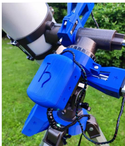
Zdjęcie 3. Uchwyt mocujący jednostkę sterującą Arduino Uno
