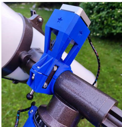
Zdjęcie 4. Mocowanie silnika krokowego- oś deklinacji
