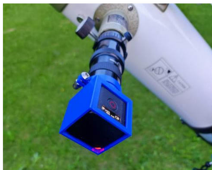
Zdjęcie 5. Mocowanie kamery bluetooth do okularu
