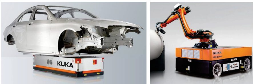
Rysunek 1. Platforma KMP 1500 przewożąca karoserię samochodu [3] oraz KMR QUANTEC - integracja platformy omnikierunkowej z robotem przemysłowym [4]
