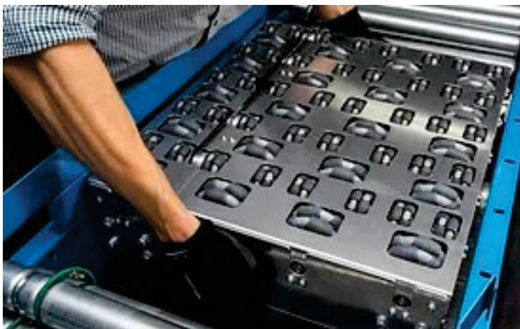
Rysunek 2. Montaż modułu przenośnika Omnia [8]
