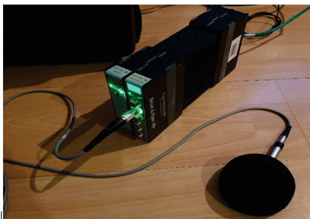
Rysunek 2. Cyfrowy miernik sygnału oraz mikrofon z osłoną przeciwwietrzną [opracowanie własne]
