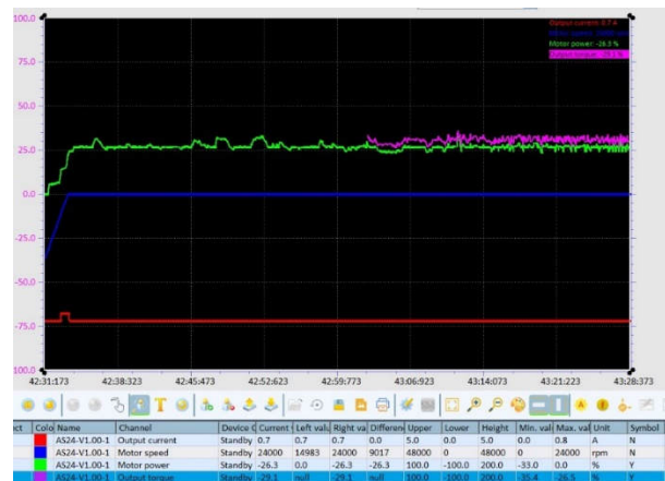
Rysunek 24. Monitorowanie parametrów falownika i silnika podczas badań [opracowanie własne]
