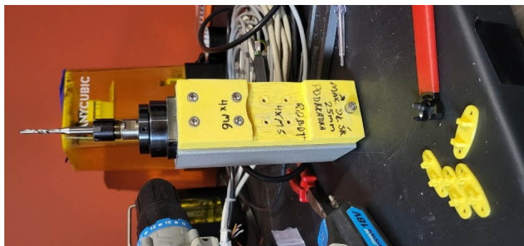
Rysunek 7. Elektrowrzeciono z zamontowanym uchwytem oraz frezem [opracowanie własne]
