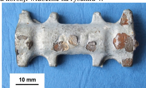
Rysunek 4. Nakładka uchwytu z widocznymi ogniskami korozji
