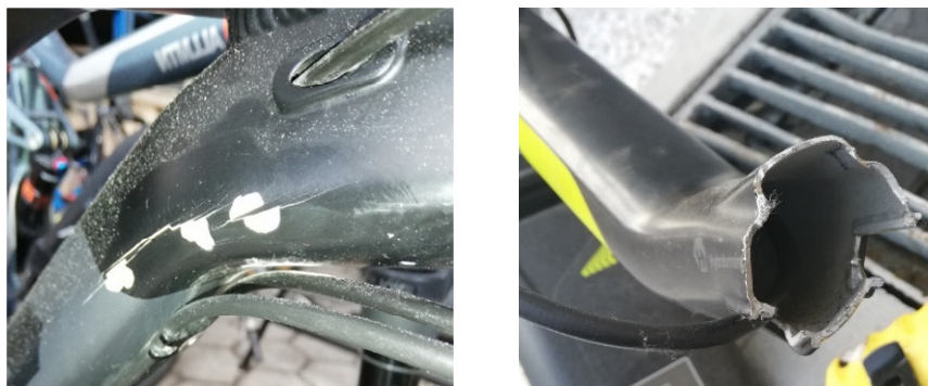
Rysunek 13. Przykłady pęknięć i złamań ram rowerów górskich
