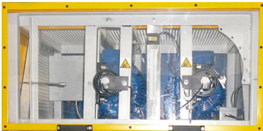
Rysunek 1. Stanowisko do badania tarcia przekładni pasowej
