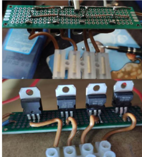
Rysunek 6. Moduł ze stabilizatorami L7812CV [1]
