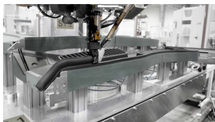
Rysunek 25. Zautomatyzowane rozwiązanie polegające na naniesieniu na podzespoły wytłoczonych ciągłych profili uszczelniających [29]
