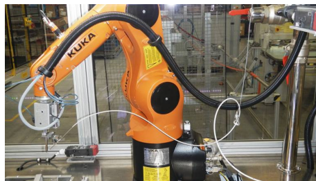
Rysunek 16. Moduł lutowniczy z robotem KR 6 R900 [21]
