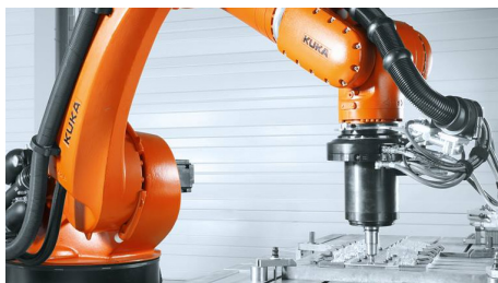
Rysunek 30. Robot w procesie zgrzewania tarcowego z przemieszczeniem [34]
