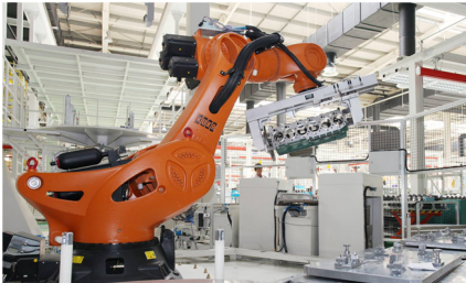
Rysunek 5. Robot o nośności tony w procesie produkcji bloków cylindrowych[9]
