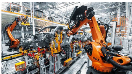
Rysunek 31. Proces budowy karoserii pojazdu elektrycznego [35]
