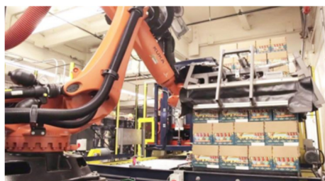
Rysunek 20. Robot chwytający skrzynki z butelkami piwa za pomocą chwytaka próżniowego [25]
