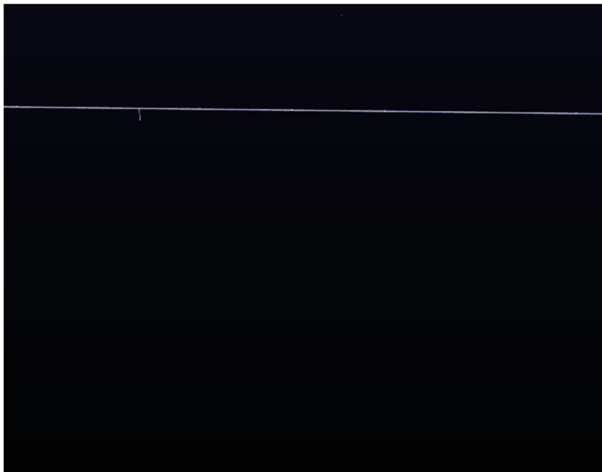
Rysunek 7 Zdjęcie z programu Livox Viewer, ukazujące brak widoczność celów przy całkowitym zadymieniu, po zwiększeniu odległości od celów do 8 metrów i 50 centymetrów
