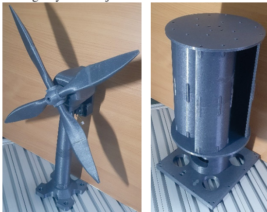
Rysunek 1. Fizyczny model turbiny wiatrowej, po lewej o poziomej osi obrotu, po prawej o pionowej osi obrotu
